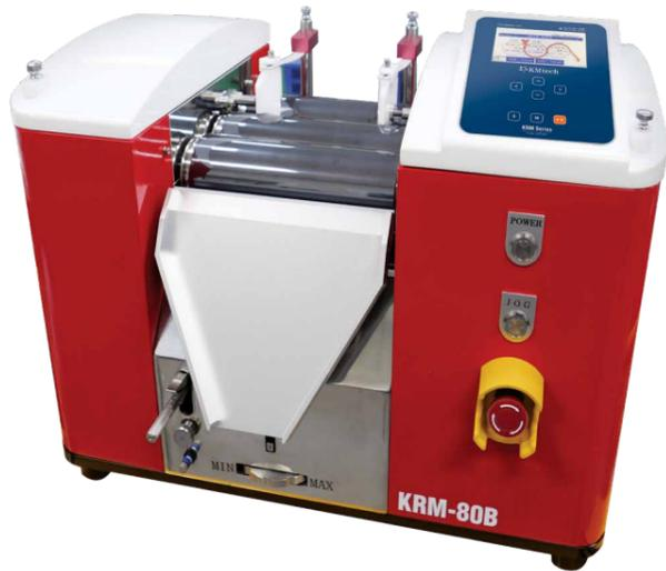
Three Roll Mill은 Milling과 Mixing의 효과를 동시에 얻을 수 있는 장비로, 고점도의 페이스트를 3개의 각기 다른 회전수로 회전하는 롤러간 미세한 간극을 통해 시료를 통과시킴으로써 샘플에 압력과 전단력을 가해서 분산처리 하는 장비이다. 각 롤러의 각기 다른 회전수 차에 따라서 미세한 간극에서의 샘플 비벼짐의 원리로 분산처리 되며 아주 미세한 간극을 일정하게 유지함이 장치의 생명이라 할 수 있다.
