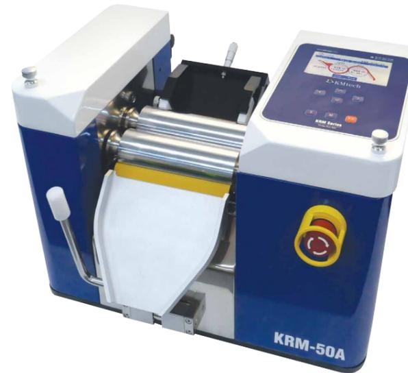
기존의 Three Roll Mill은 세개의 롤러를 갖고 있으나 2nd와 3rd의 롤러의 역할은 샘플의 믹싱용 또는 투입량의 조절용으로 사용되며, 실질적으로 분산의 역할은 1st와 2nd 롤러 사이의 Micro Gap을 통과하면서 분산이 이루어진다. 그러나 롤러의 손상을 가하는 부분은 2nd와 3rd 롤러가 안으로 밀려들어 가는 방향이기 때문에 여기에서 문제가 발생을 한다. KRM-50B 모델을 분산 목적이 아닌 3rd 롤러를 제거하고 샘플을 투입할 수 있는 Scraper방식을 변경하여 세척시 말림현상이 없으며, 유지관리가 수월한 구조로 설계 되었다.
